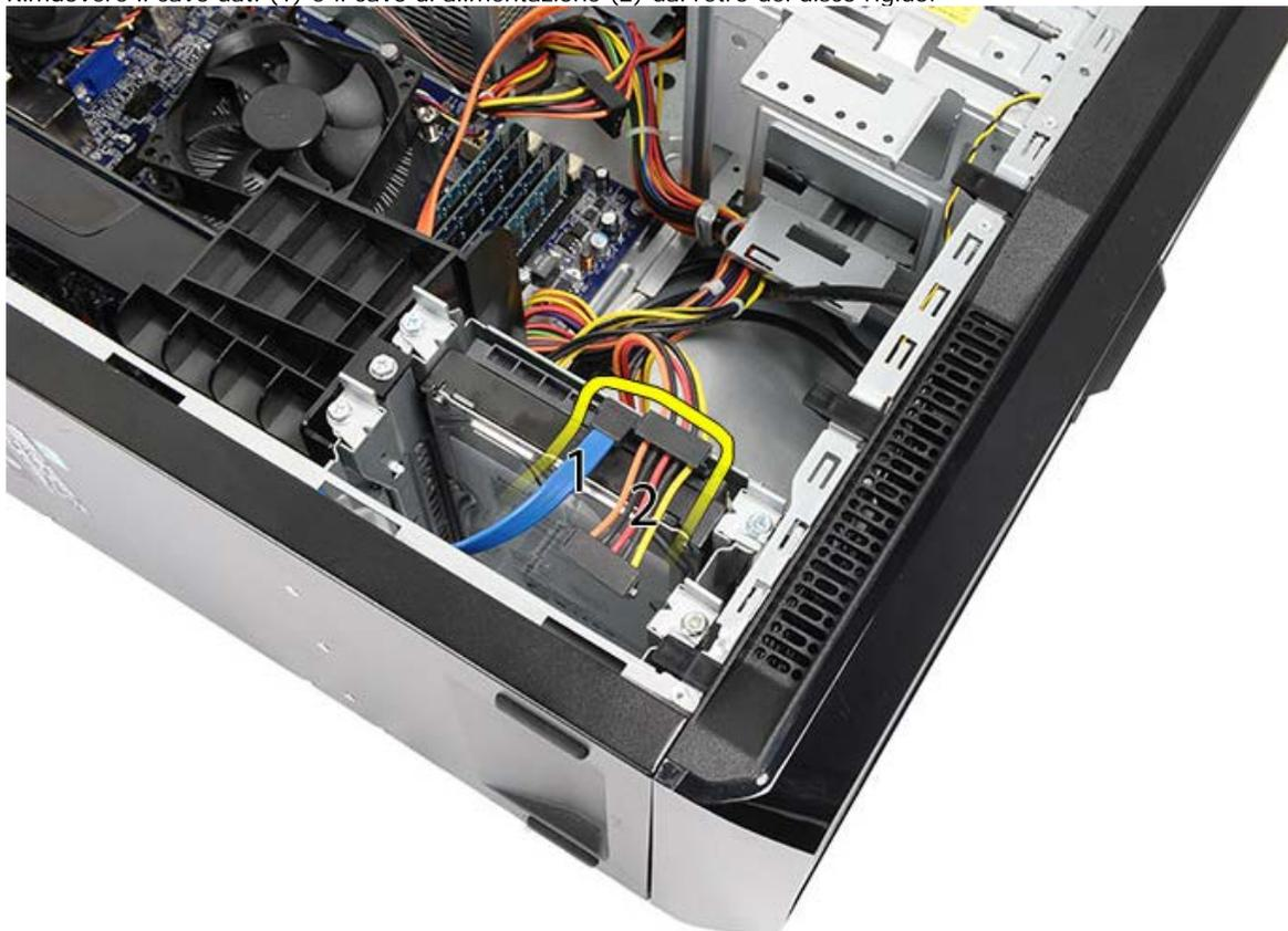
4. Rimuovere le due viti che fissano la gabbia del disco rigido al telaio.
