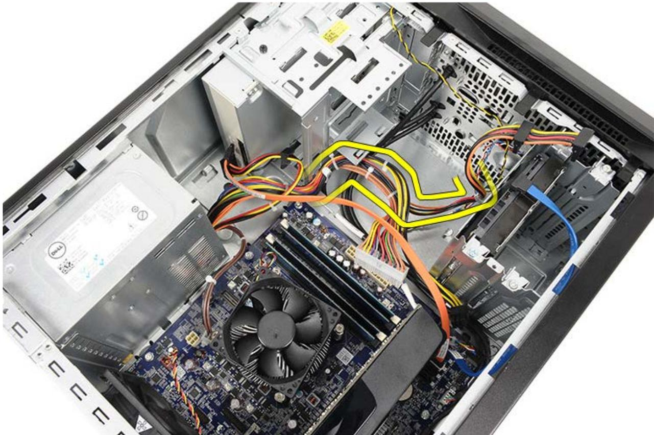
6. Rimuovere le viti che fissano l'alimentatore al telaio del computer.
