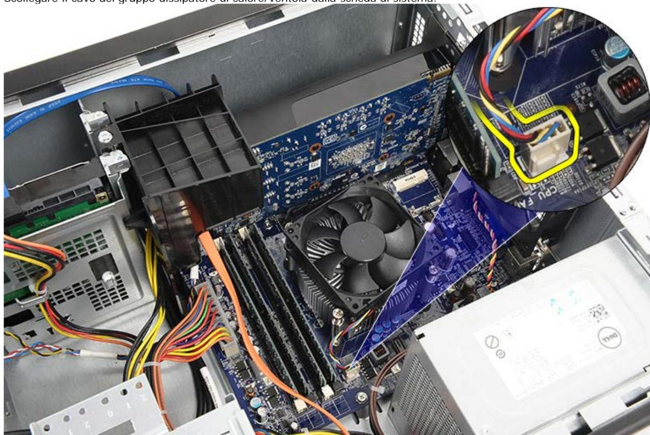
4. Allentare le quattro viti di fissaggio che fissano il gruppo dissipatore di calore/ventola alla scheda di sistema.
