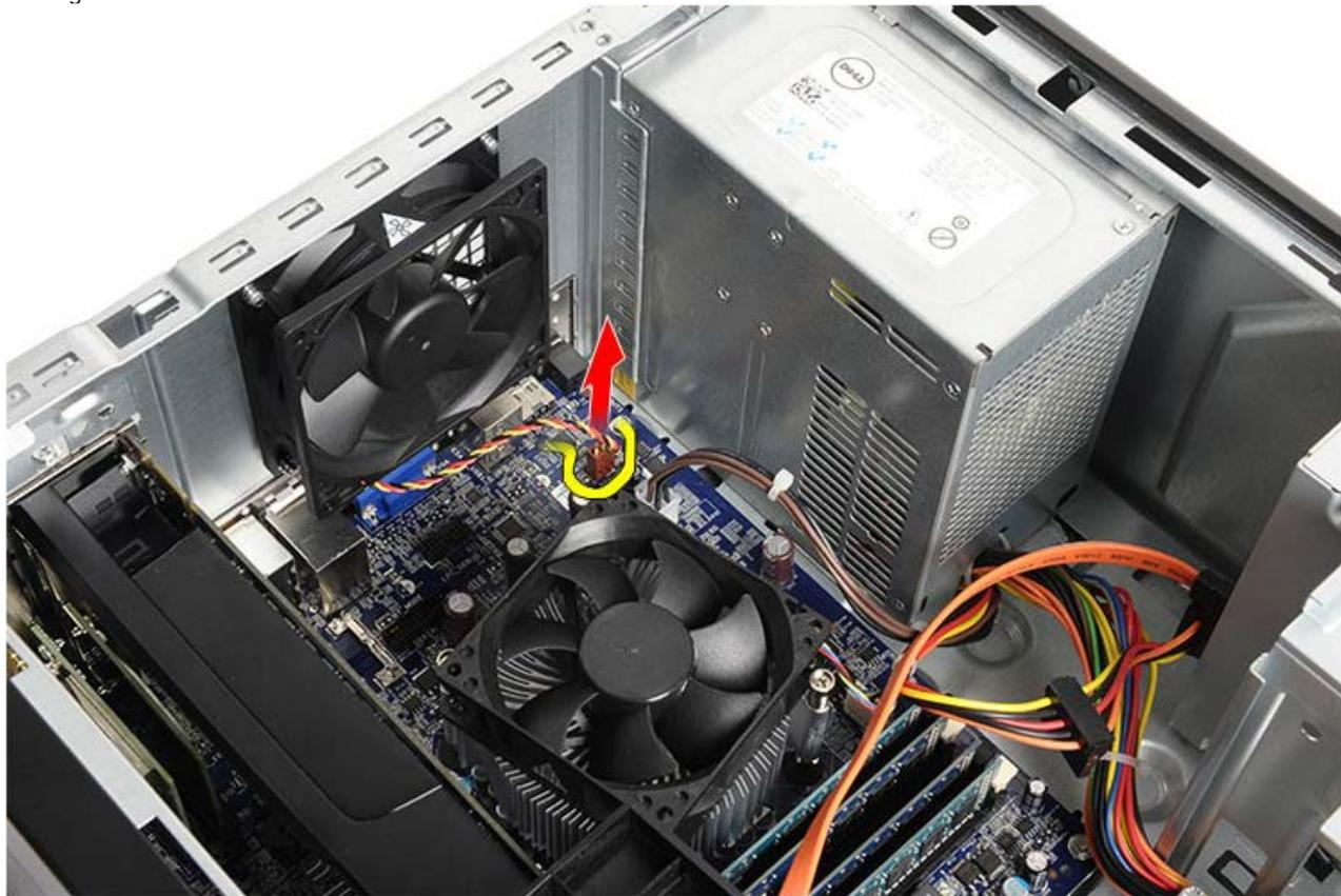
4. Tenendo la ventola del telaio in posizione, rimuovere le quattro viti che fissano la ventola al telaio.
